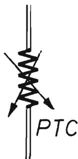
Fig. 5 - Simbolo elettrico della resistenza a coefficiente di temperatura positivo universalmente utilizzato negli schemi teorici.
